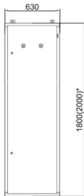
Панель с аппаратурой АВР
