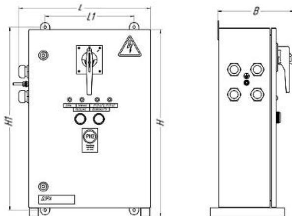
Рисунок 2. Общий вид, габаритные и установочные размеры ВАП-II-О-X-01-38
