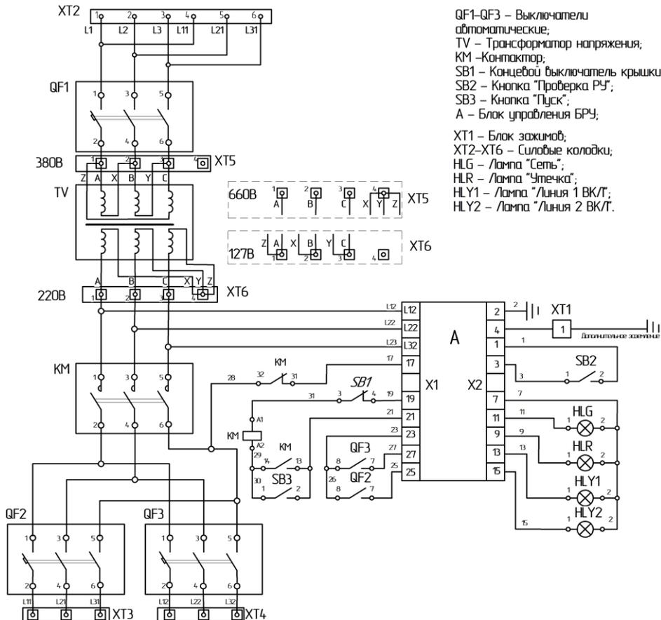
Рисунок 3. Схема ВАП-II-О-Х-01
